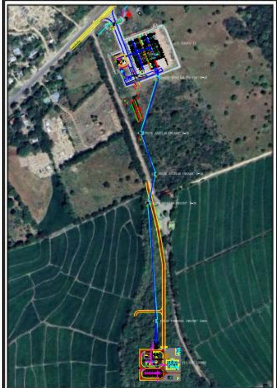
Figura 5: Trazado de ruta de línea de transmisión de 138 kV del proyecto de generación fotovoltaica denominado “ ENESOLAR-I/APAS ” para la inyección de hasta 52.132 MW AC a la Subestación Sébaco 1.
