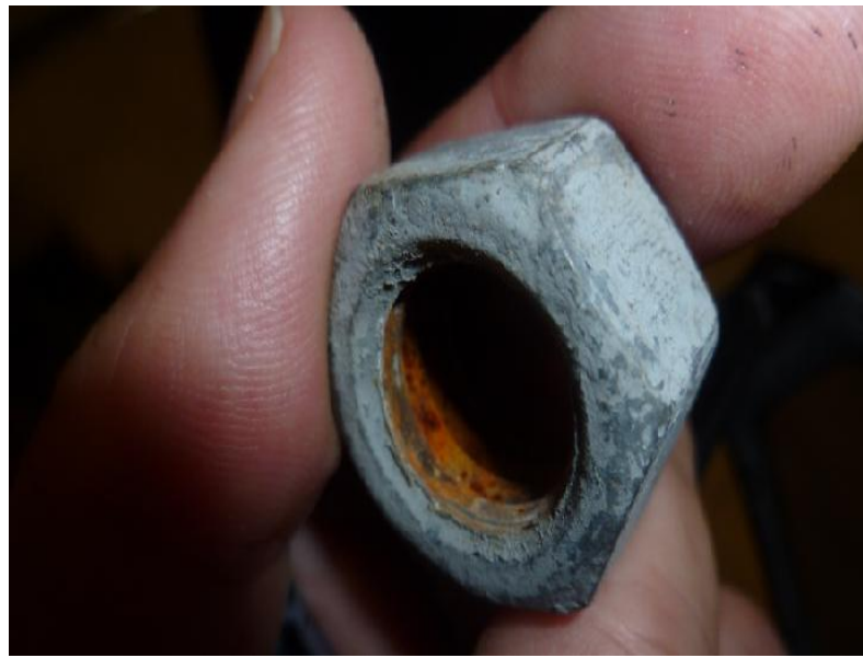
Ejemplo tuercas cambiadas por oxidación
