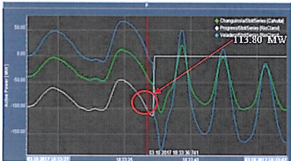
Siendo el caso que al momento del disparo de la línea Río Claro – Progreso 230 kV, se observó en la mencionada línea de transmisión un flujo de potencia activa de 113.80 MW y una frecuencia de 60.270 Hz, se puede concluir que la operación del relé ubicado en la subestación Río Claro operó
